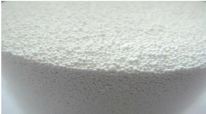
Der mit diesem **maicat**<sup>®</sup> - **KalkschutzVerfahren** auskristallisierte Kalkanteil aus Calcit und Magnesium steht für eine Schutzschichtbildung mittels Ionenbindung auf den metallischen Rohroberflächen als Korrosionsschutz zur Verfügung. Dabei handelt es sich nicht um eine Kristallisation von Mineralkristallen auf den Rohroberflächen in Form einer fortschreitenden Verkalkung.
